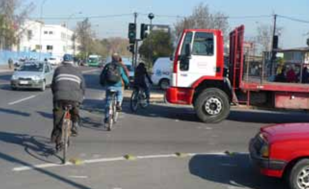
Foto 40: Un ejemplo de mala intersección, en la ciclovia de Pajaritos, Estación Central. La vía para los ciclistas no está señalizada, produciendo conflicto con los vehículos.
