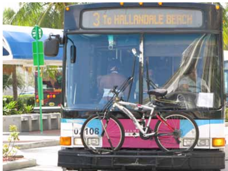
Foto 13: Parrillas para bicicletas en los buses de Miami, EEUU, una medida que Transantiago tiene que emular.
