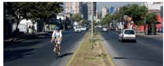
Foto 47: La “mediana” separa los dos sentidos del flujo vehicular reduciendo el espacio de circulación, induciendo menores velocidades. Av. Irarrázabal.
