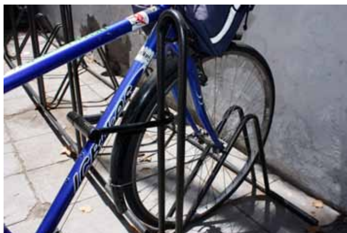
Fotos 74 y 75: Esta es una adaptación realizada por Pharo 4 con asesoría de Ciudad Viva. Se apoya en la rueda, pero permite asegurar también el marco.
